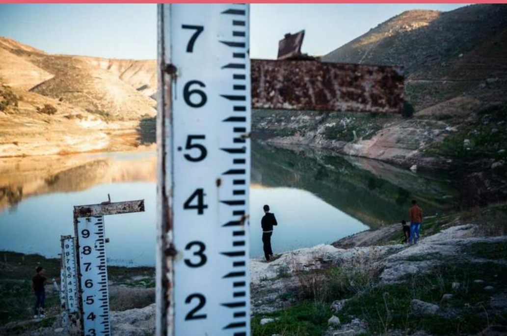
Échelle des crues sur le lac de barrage de Ziglab, affluent du Jourdain
